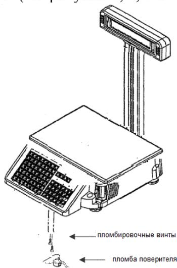
Рисунок 6 - Схема опломбирования весов SM-300 (за исключением исполнения Н)
