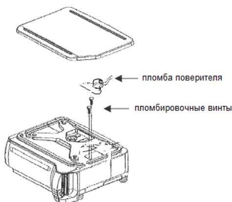
Рисунок 8 - Схема пломбирования весов SM-5000, 5400, 5500 (за исключением исполнения Н)
