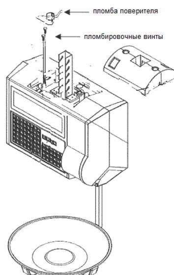
Рисунок 9 - Схема пломбирования весов SM-300, 500, 5000, 5400, 5500 в исполнении Н
